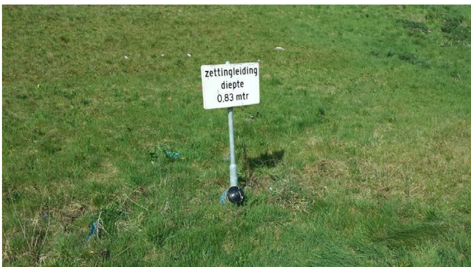
Foto: Duidelijk markering zettingsleiding.
